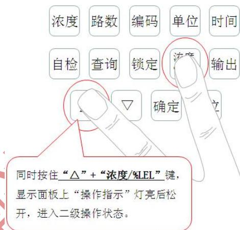
当进入二级操作状态后，可对控制器进行“锁定”、“自检”以及“复位”，操作完毕后自动退出，再次操作需重新进入。
