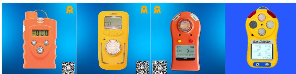
6.使用的环境条件是否合适，温度，压力是否允许，正常情况下的有毒气体检测仪，只适用于常规的温度范围-20 到 50 度，湿度 95%不凝结露，否则会导致传感器的损坏，所以使用时必须要看工作的环境条件是否合适，如果不合适就需要加装一套气体预处理系统。
